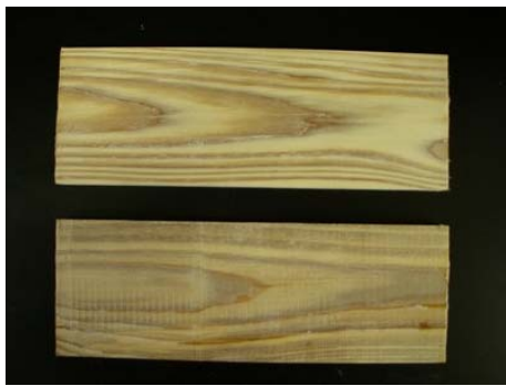
写真1 リン酸系薬剤を注入したスギ 辺材試験片（注入2週間後）
