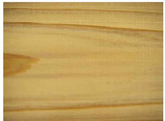
写真2 リン酸系薬剤を不溶性物質化したスギ辺材 (特許出願中, 出願番号2010-275225)
