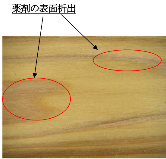
写真1 リン酸系薬剤を注入したスギ辺材
